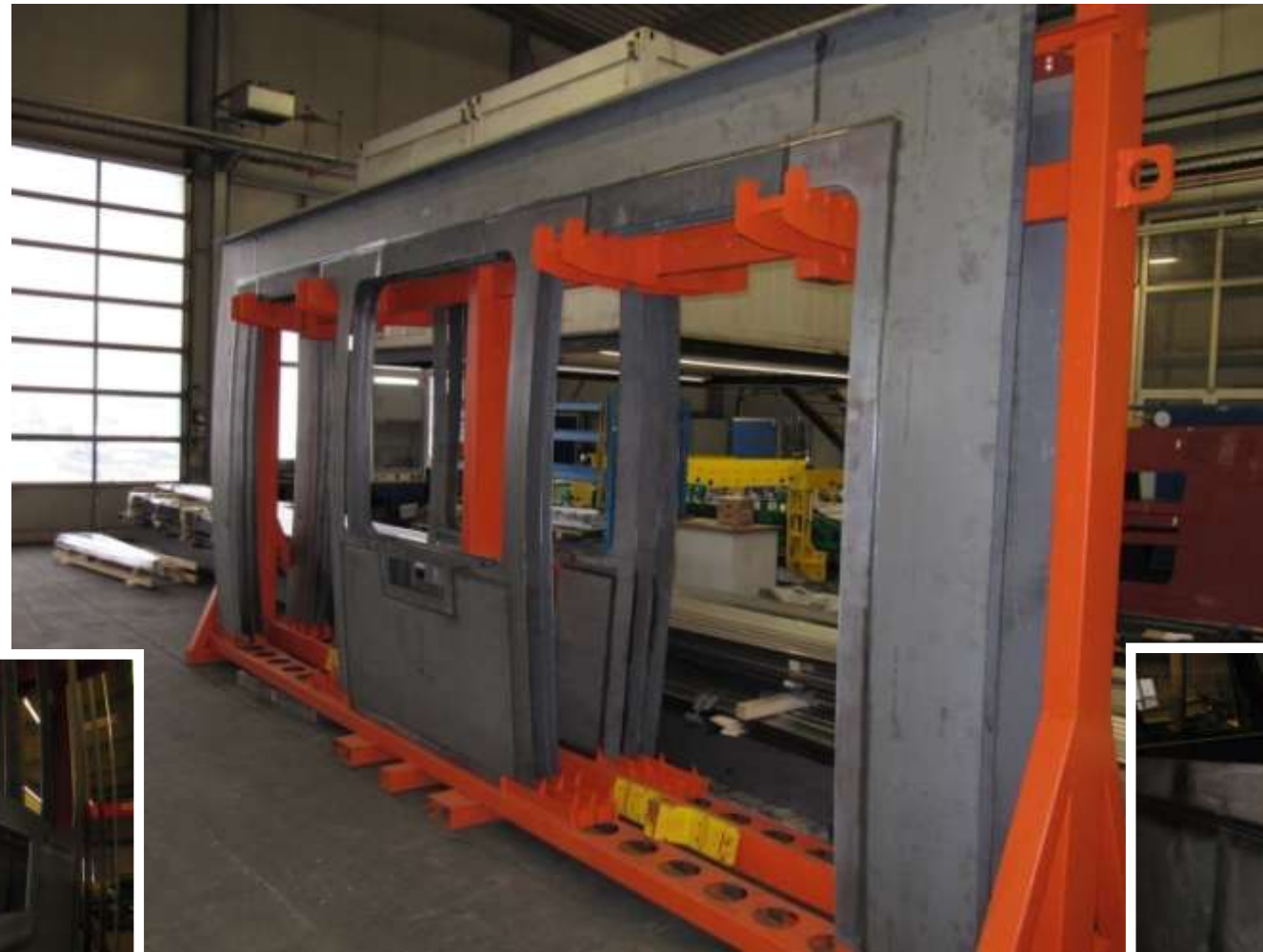
Lasergeschweißte Seitenwandbleche Straßenbahn S355J2CuC+N t=2mm und S355J2WC+N t=4mm
