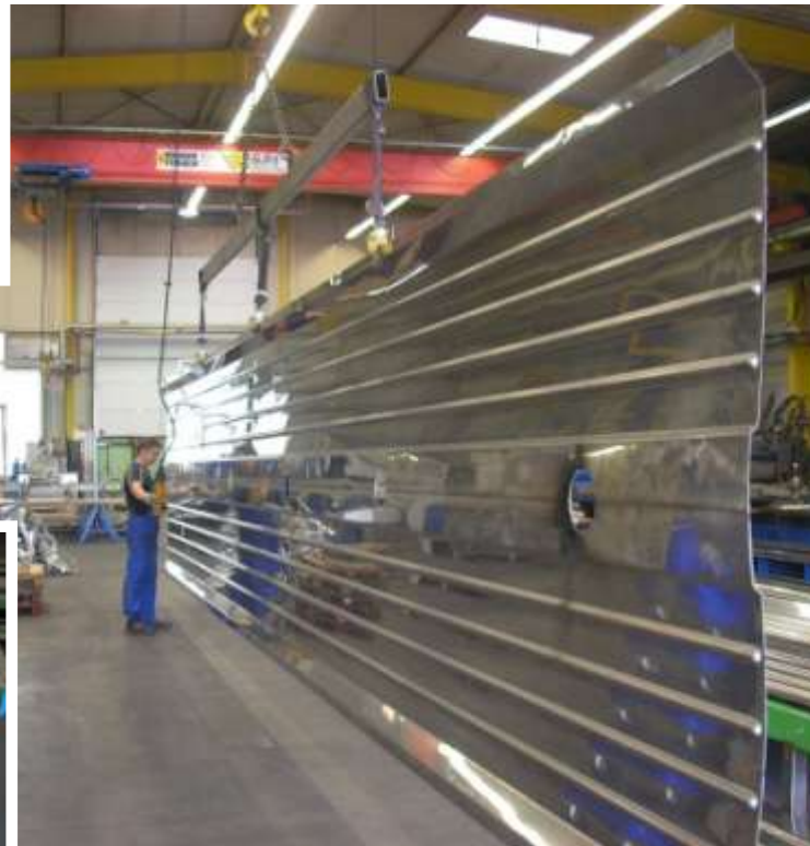
verschiedene Seiten- und Dachblechvarianten lasergeschweißt
