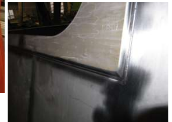
Lasergeschweißte Seitenwandbleche Straßenbahn S355J2CuC+N t=2mm und S355J2WC+N t=4mm
