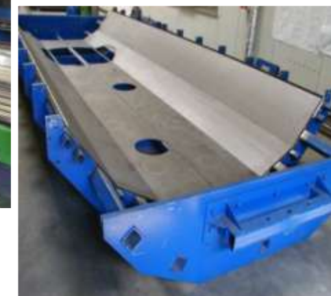
verschiedene Seiten- und Dachblechvarianten lasergeschweißt
