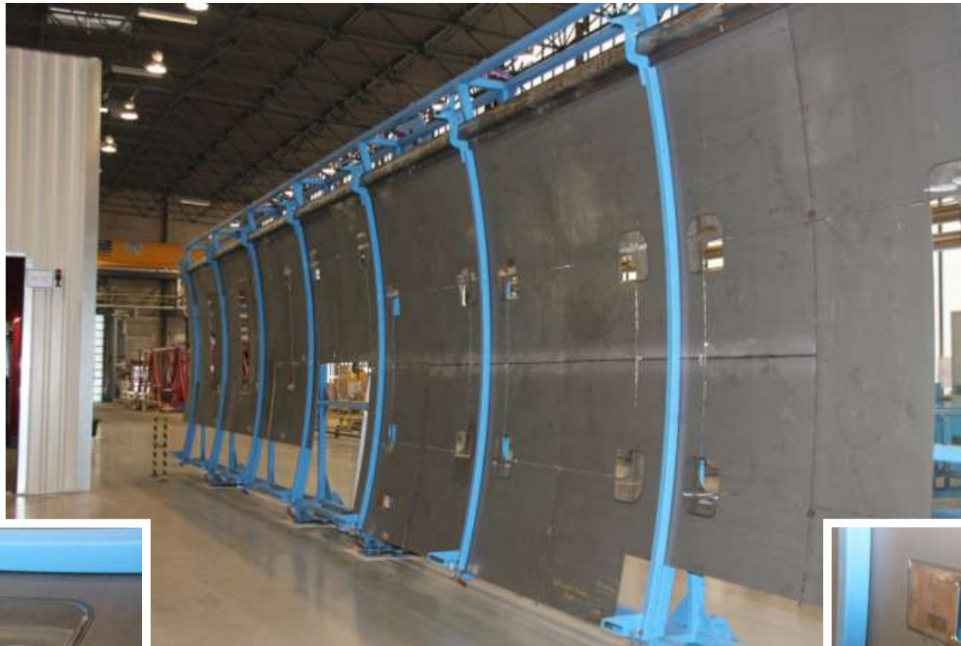
Lasergeschweißte Seitenwandbleche Abmessungen: 16,0 x 3,5m Material S355J2C+N
