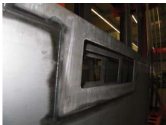
Lasergeschweißte Seitenwandbleche Straßenbahn S355J2CuC+N t=2mm und S355J2WC+N t=4mm
